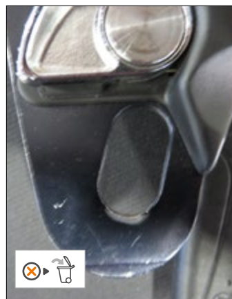
• Деформация соединительного отверстия вследствие срыва
